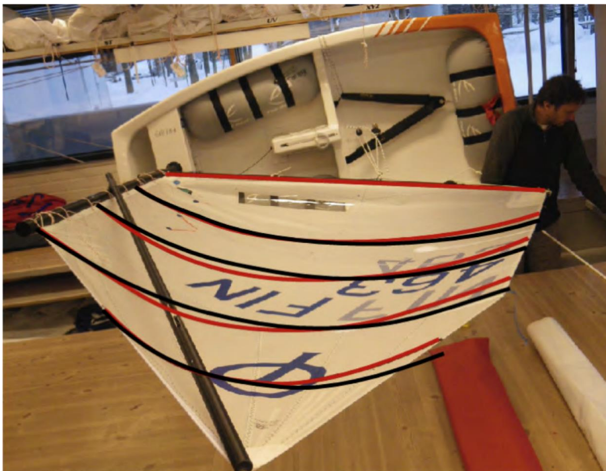
Vliv utažení spritu na tvar plachty. Červené křivky jsou při napnutém spritu, černé při povoleném.
